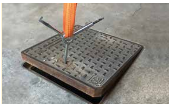
Configurazione 4 Utilizzo in sinergia con una cinghia a strozzo per le operazioni di sollevamento.
