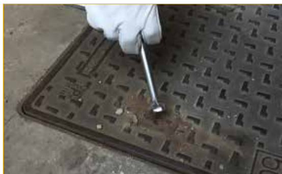
Configurazione 3 Estremità a "T" da utilizzare come aletta o chiavarda di inserzione nelle asole.
